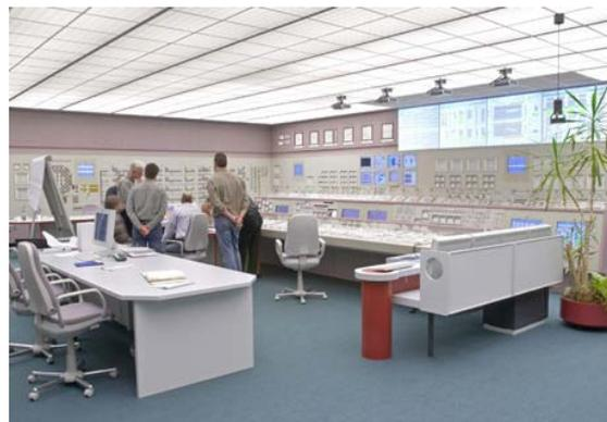
Abbildung 6: Der D-42 Simulator stellt eine exakt nachgebildete Leitwarte des Kraftwerks Philippsburg 2 dar, in dem diverse Szenarien trainiert werden können.
