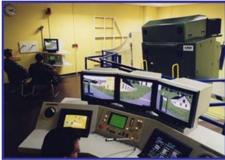
Die Fahrerkabine ist dem jeweiligen Panzertyp im Bereich des Fahrers original nachempfunden. Über die Sichtkanäle wird die computer-generierte Außensicht auf die Innenseite des Doms projiziert. Das Fahrgelände besteht aus ca. 24 km<sup>2</sup> der Bundesrepublik Deutschland nachempfundenen Gelände. Die Witterungseinflüsse (Sonne, Regen, Schnee, Nebel) sind frei wählbar.
