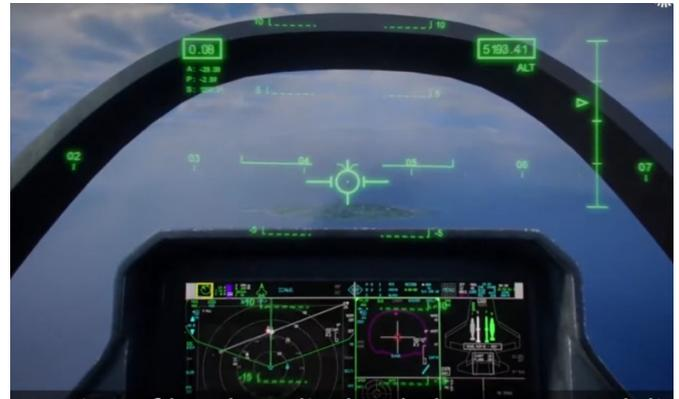
Abbildung: Blick des/der Pilot\*in durch das Helmvisier (Collins Aerospace CEVS JSF Helmet Mounted Display <https://youtu.be/TqGe4Pr5qvg>)
