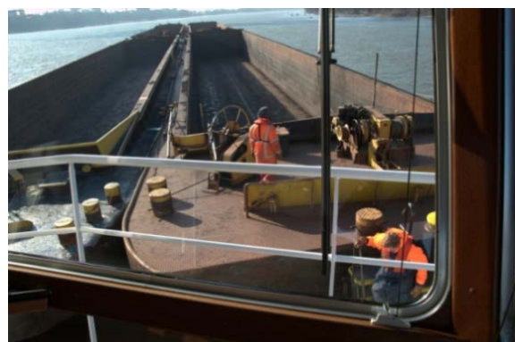
Abbildung 5: Matrosen und Schiffsjungen beim „Kuppeln“ der Schubleichter
